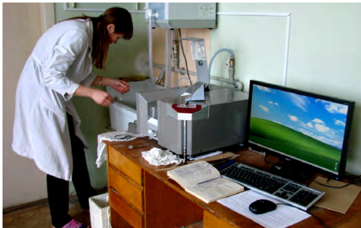
Бондаренко Л.С. проводит анализ реологических свойств зерна разных образцов озимой мягкой пшеницы на приборе Миксолаб (Франция)
